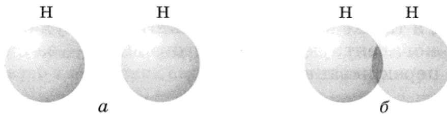
Рис. 3. Образование связи в молекуле H_2 : a — отдельные орбитали; б — перекрывание орбиталей
